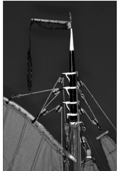
Masttop met blokken.
